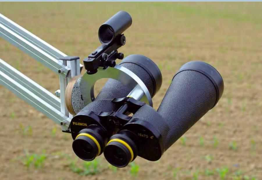
**Abb. 7: Für eine klemmungsfreie Höhenbewegung** muss das Fernglas im Schwerpunkt montiert sein. Dies wird mittels einer Distanzhülse realisiert.
