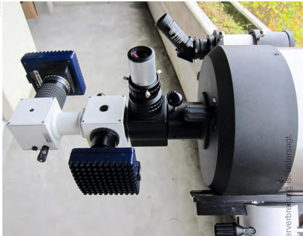
▲ Abb. 3: DADOS-Spektrograf mit Klappspiegel am 8"-SCT. Die DSI III (links) ist als Aufnahme- und die DSI II (rechts) als Spaltkamera eingesetzt. Das Schwalbenschwanzprofil ermöglicht ein problemloses Balancieren des gesamten Aufbaus.
