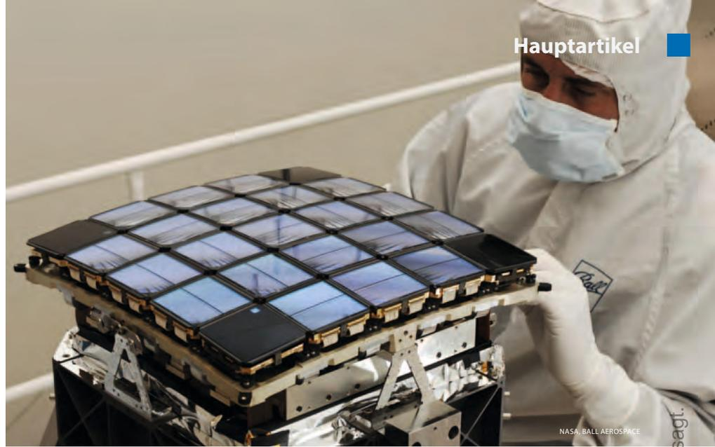
▲ Abb. 3: Die Kameras des Exoplanetensuchers Kepler setzen sich aus 42 CCD-Elementen mit je 25mm x 50mm und 1024x2200 Pixeln zusammen. Insgesamt ergeben sich so 95 Megapixel.
