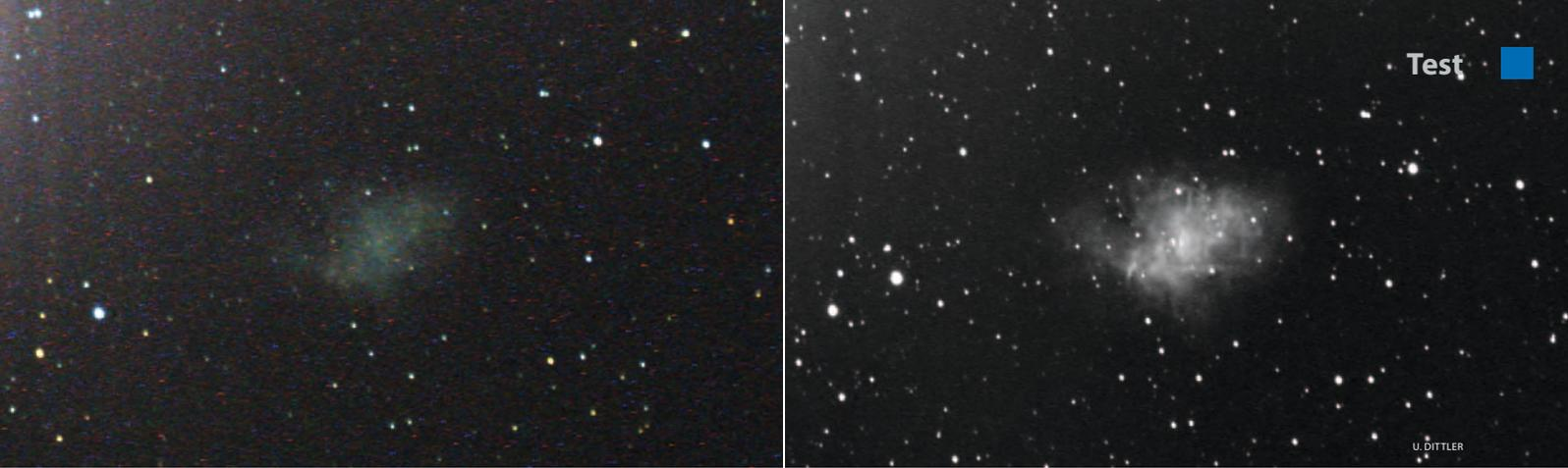
▲ Abb. 6: Bei diesen unbearbeiteten Aufnahmen von M 1 fällt das Verstärkerrauschen auf, sowohl beim Farbmodell DFK 51 (links) als auch beim monochromen Modell DMK 51 (rechts). Summenbild aus je 10 Aufnahmen à 60s Belichtungszeit, 130mm-Refraktor bei 1000mm Brennweite.
