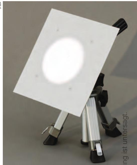
▲ Abb. 3: **Improvisierter Projektionschirm**, der auf einem Kleinstativ genau ausgerichtet werden kann. Abgebildet sind auch die vier Passkreuze um das Abbild der Sonne.
