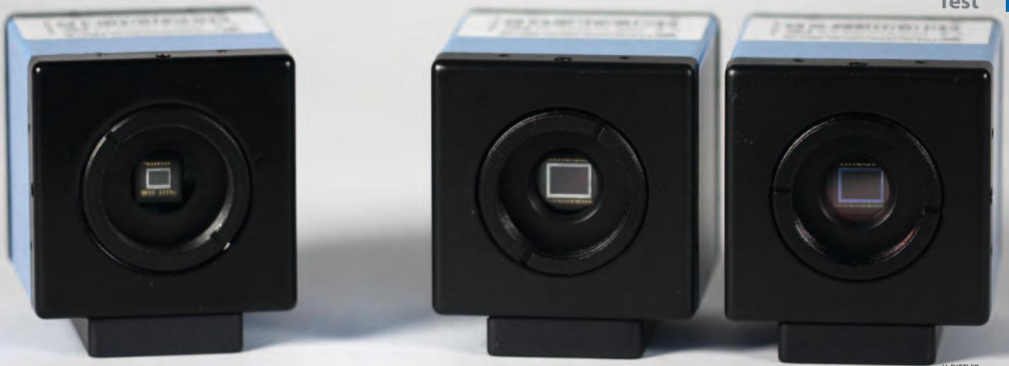
▲ Abb. 2: Der Chip der beiden 51er-Kameras (rechts) im Vergleich zu dem der von Planetenfotografen geschätzten 21er-Baureihe (links).
