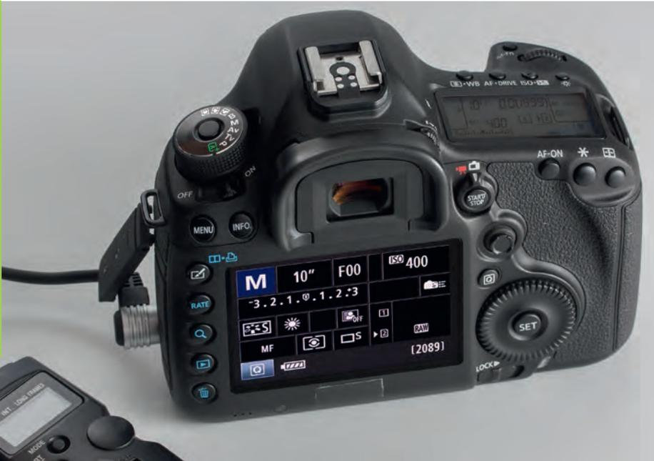
◀ Abb. 1: Vorbereitete Testkamera, bei der alle notwendigen Einstellungen vorgenommen worden sind: die Wahl der Bildaufzeichnung im RAW-Format, die manuelle Belichtungssteuerung mit 10s Belichtungszeit und die manuelle Einstellung des ISO-Wertes, hier ISO 400.
