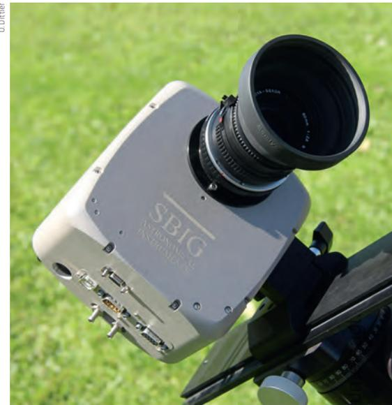
▲ Abb. 2: Mittelformatobjektive älteren Datums lassen sich mit modernen CCD-Kameras zu effektiven Weitfeldinstrumenten kombinieren, wie hier ein 80mm-Mittelformatobjektiv von Mamiya an einer SBIG STL-11000.
