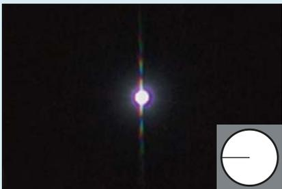
▲ Abb. 5: Ein dünner Draht über der halben Objektivöffnung - trotzdem treten dennoch zwei gleich helle Spikes in Erscheinung.
