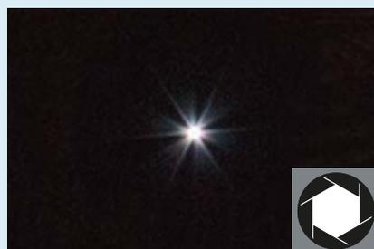
▲ Abb. 9: Abblendung um nur eine halbe oder eine volle Stufe lässt Spikes entstehen, deren Aussehen von der Form der Blende abhängt.
