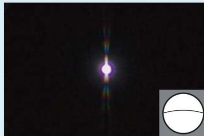
▲ Abb. 6: Ein etwas gebogener Draht mittig über der Objektivöffnung erzeugt mehr oder minder unscharfe Spikes. Je nach Form können auch Doppel- und Mehrfachspikes entstehen.
