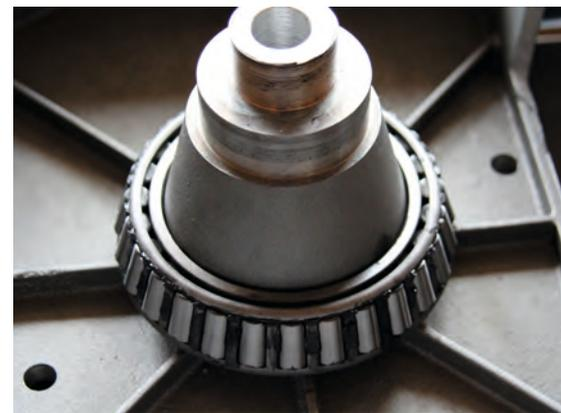
▲ Abb. 2: Der Einbau des neuen Kegelrollenlagers in die R.A.-Achse der Montierung.
