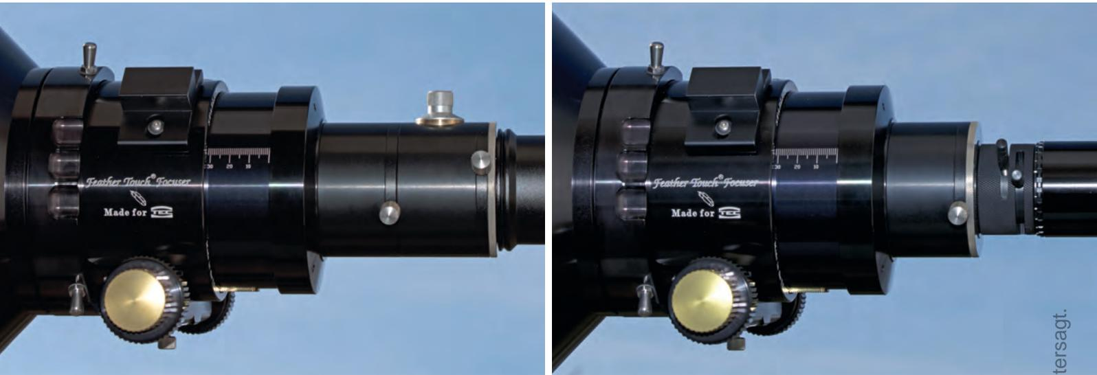
▲ Abb. 4: Montage der Korrektoren am Okularauszug des 180mm-Refraktors. Sowohl beim Pierro Astro ADC (a) als auch beim Gutekunst-ADC (b) wird als Barlow-Element der 1,5x-Fokusextender von Gutekunst Optiksyste me eingesetzt.
