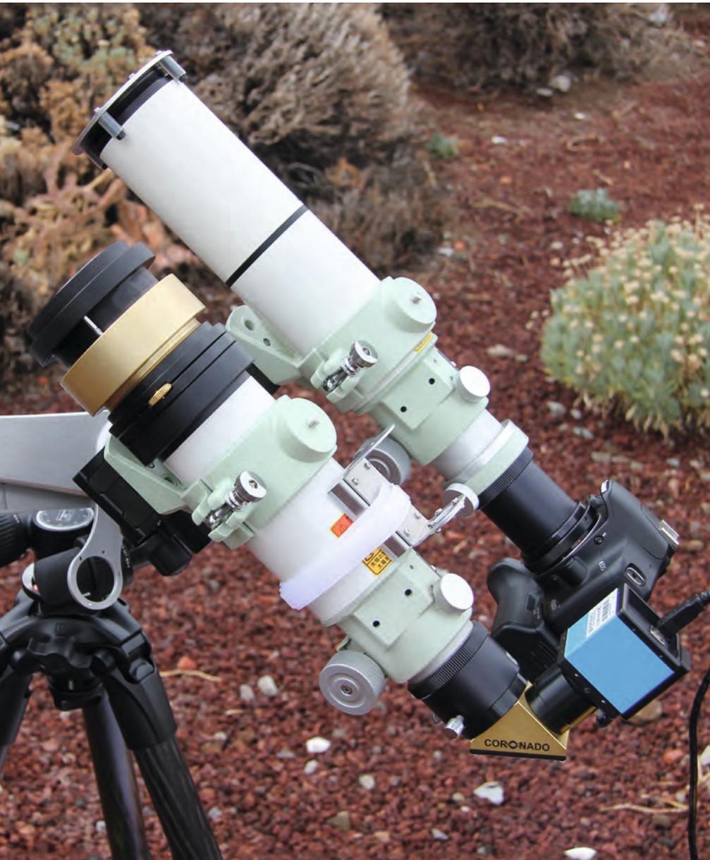
▲ Abb. 6: Für Weißlicht und Ha-gerüstet: die verwendeten Reiseoptiken, zwei 60mm-Refraktoren mit unterschiedlichen Sonnenfiltern.
