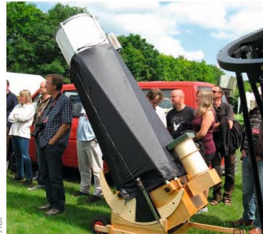
▲ Abb. 2: Dieses selbst gebaute Dobson-Teleskop hat eine Brennweite von 2500mm. Den Preis erhielt sein Konstrukteur allerdings für den ebenfalls selbst gebauten 7"-Sucher.
