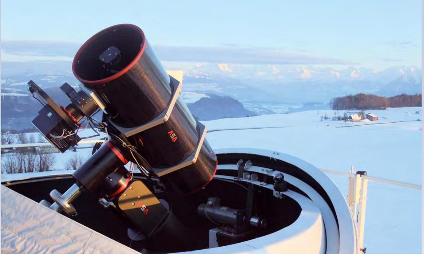
**Abb. 2: Das robotische Teleskop** ZimSMART zur Suche nach Weltraumschrott.
