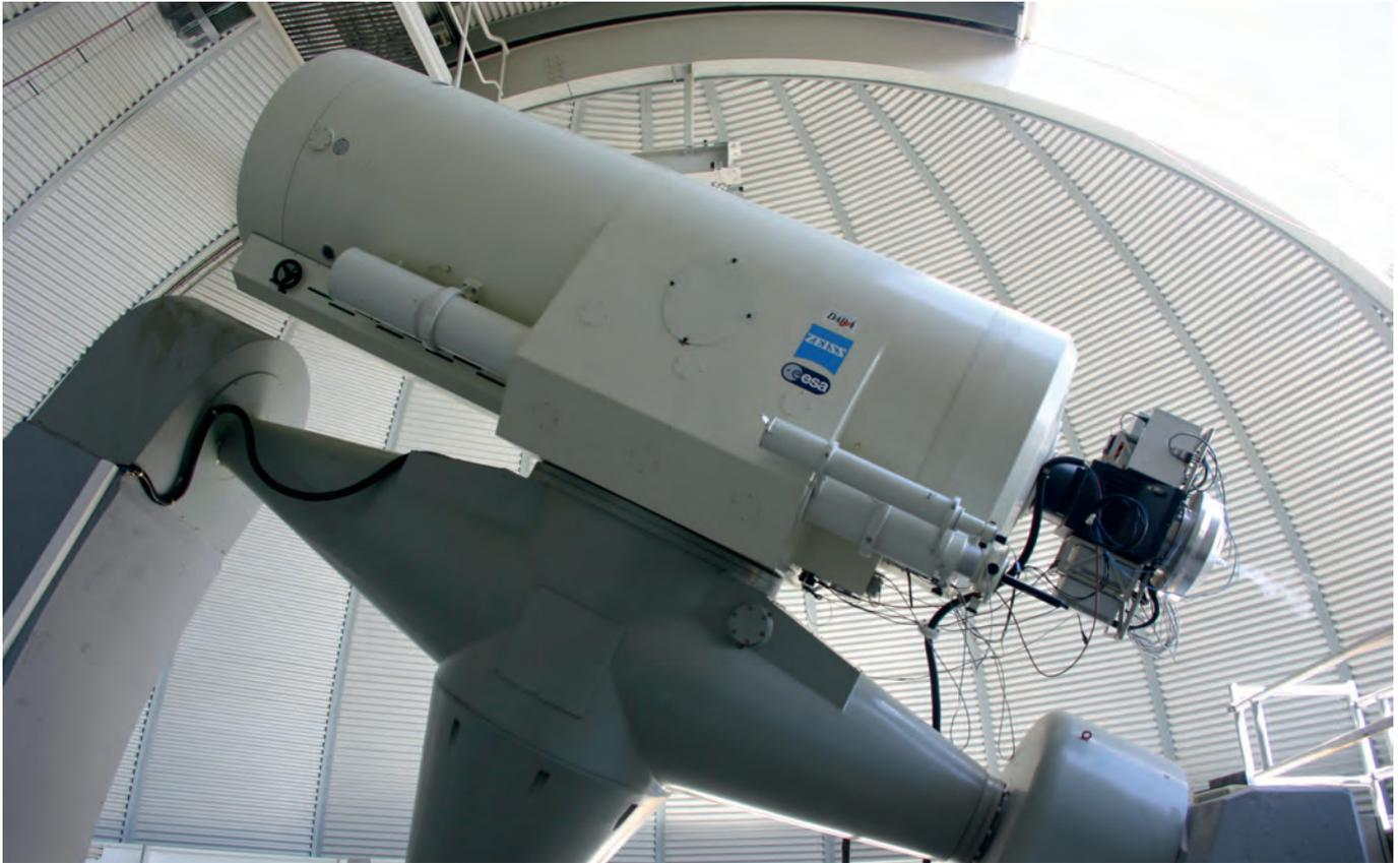
▲ Abb. 2: Das 1000/4500mm-Teleskop auf englischer Montierung.
