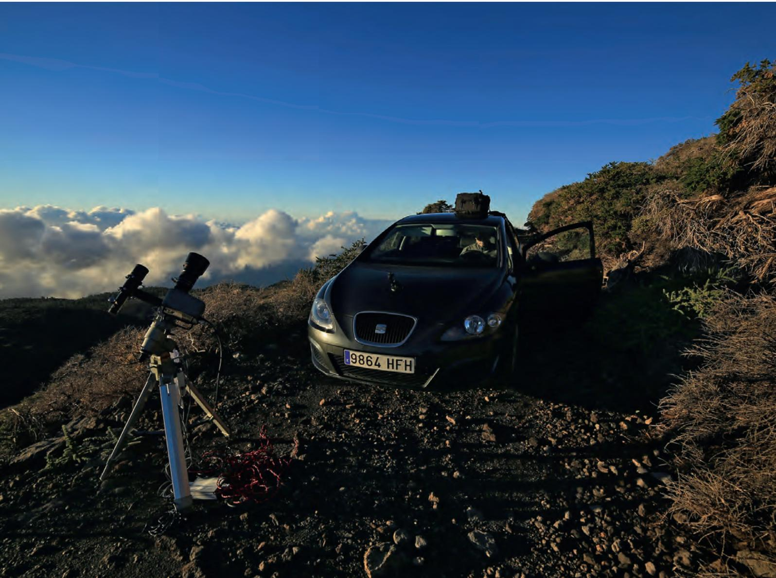
▲ Abb. 3: Beobachtungsstandort für Abb. 2 mit vorbereiteter Montierung, darauf eine SBIG STL-11000M CCD-Kamera und ein 200mm-Teleobjektiv (Ausrüstung für Abb. 4).
