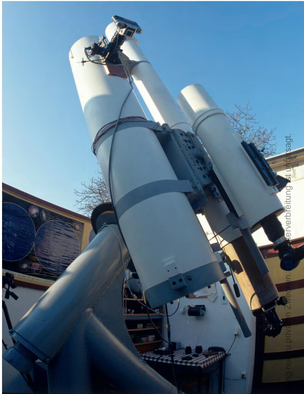
▲ Abb. 2: Die Sternwarte des Autors 2005: 10"-Newton, 6"-Refraktor und 4,4"-Kometensucher auf schwerer deutscher Montierung (alles Eigenbau).
