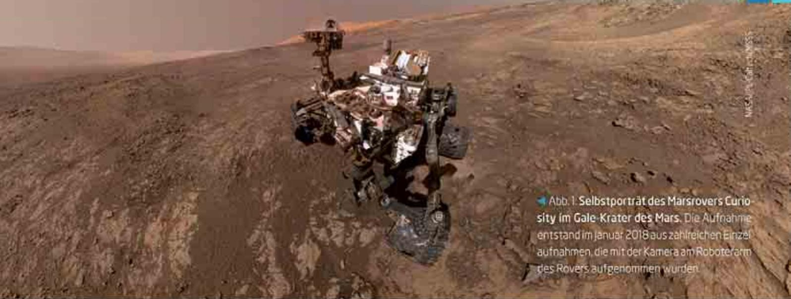
➤ Abb. 1: Selbstporträt des Marsrovers Curiosity im Gale-Krater des Mars. Die Aufnahme entstand im Januar 2018 aus zahlreichen Einzelaufnahmen, die mit der Kamera am Roboterarm des Rovers aufgenommen wurden.
