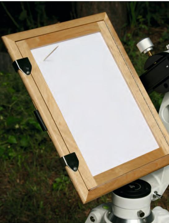
▲ Abb. 2: Ein Feldbuch mit einer weißen Zeichenfläche wurde an eine Montierung mit Feinbewegungen montiert. Am einfachsten funktioniert das mit kräftigem Klebeband. Die Montierung gestattet es auf einfache Weise, das Feldbuch senkrecht zur Sonne auszurichten. Der Zahnstocher dient als Schattenwerfer. Für die Benutzung bei Mondfinsternissen ist es besser, statt des Schattenwerfers eine einfache Peileinrichtung aus einer dünnen Papp- oder Papierhöhle anzubringen.
