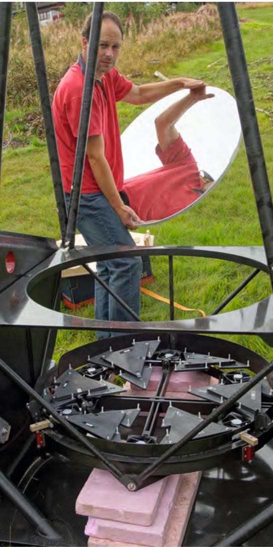
◀ Abb. 7: Der Hauptspiegel wird zur Beobachtung jeweils ein- und ausgebaut. Dadurch kann der Spiegel an einem absolut trockenen Ort gelagert werden, ist beim Transport besser geschützt und die Spiegelzelle benötigt keine Transportsicherungen. Andererseits fällt ein zusätzlicher Arbeitsschritt an – volle Konzentration beim Einlegen und später beim Herausnehmen.
