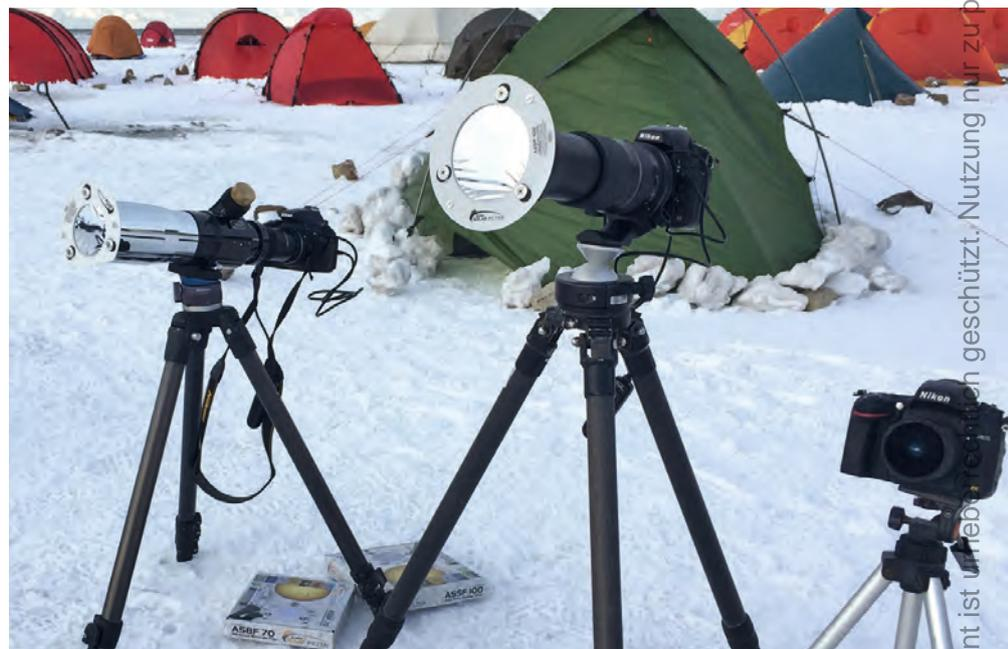
schwimmend gelagerten Rahmen befestigt, welcher den gleichen Ausdehnungs-Koeffizienten hat wie das Filter-Material. So werden Temperaturschwankungen ausgeglichen und hohe Vergrößerungen möglich.
