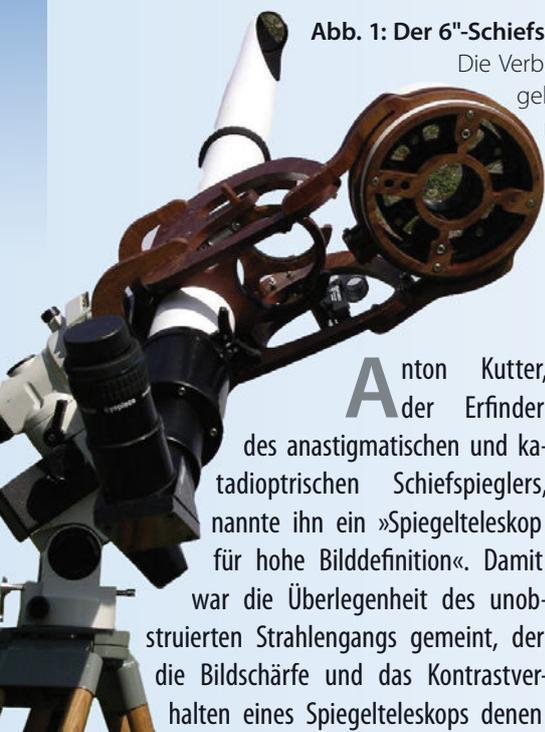
**Abb. 1: Der 6"-Schiefspiegler von Liebers** mit 4200mm Brennweite. Die Verbindung zwischen Hauptspiegel- und Fangspiegeltubus zeichnet sich durch ein filigranes Erscheinungsbild aus.
